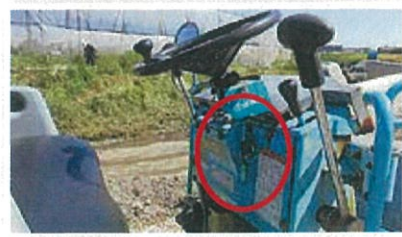
斜路にローラーが置いてあり輪留めがなく、鍵もつけばなしであった。
